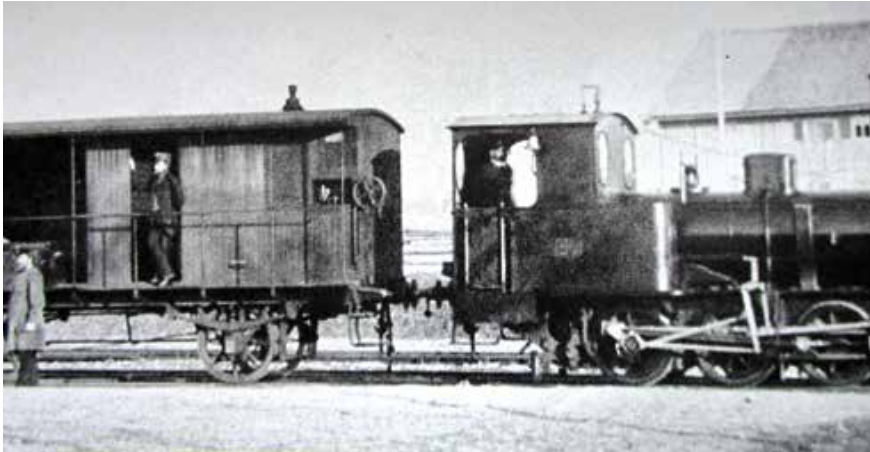
1888 fuhr der erste Zug von Sonthofen nach Oberstdorf. Mit einem noch eher leichten Lokomotivenmodell, da die Brücken noch nicht so tragfähig waren.
